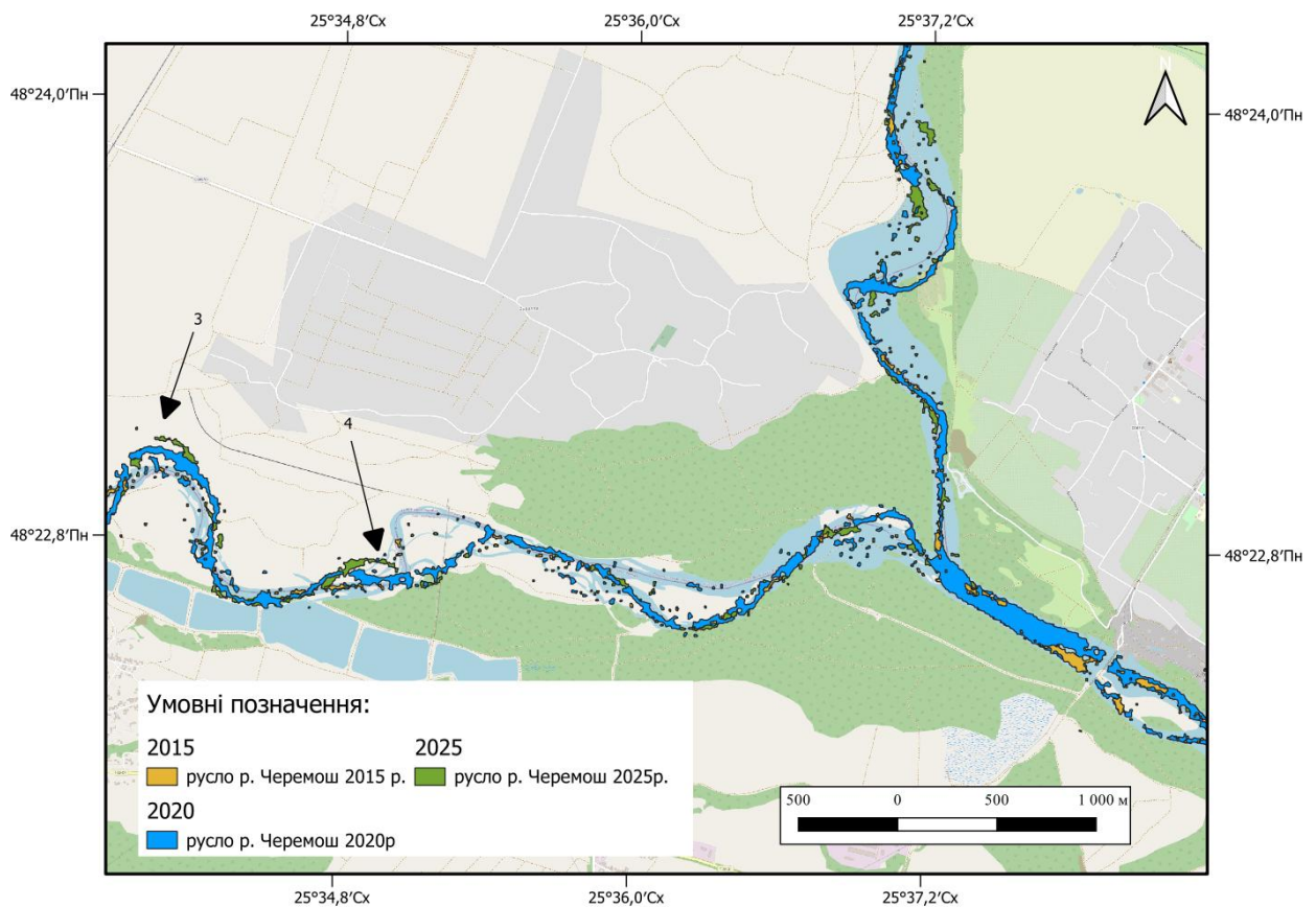
Рис. 8. Картосхема ретроспективного моніторингу планових деформацій русла р. Черемош у межах багаторічної смуги руслоформування за результатами обробки радарних знімків у середовищі QGIS
