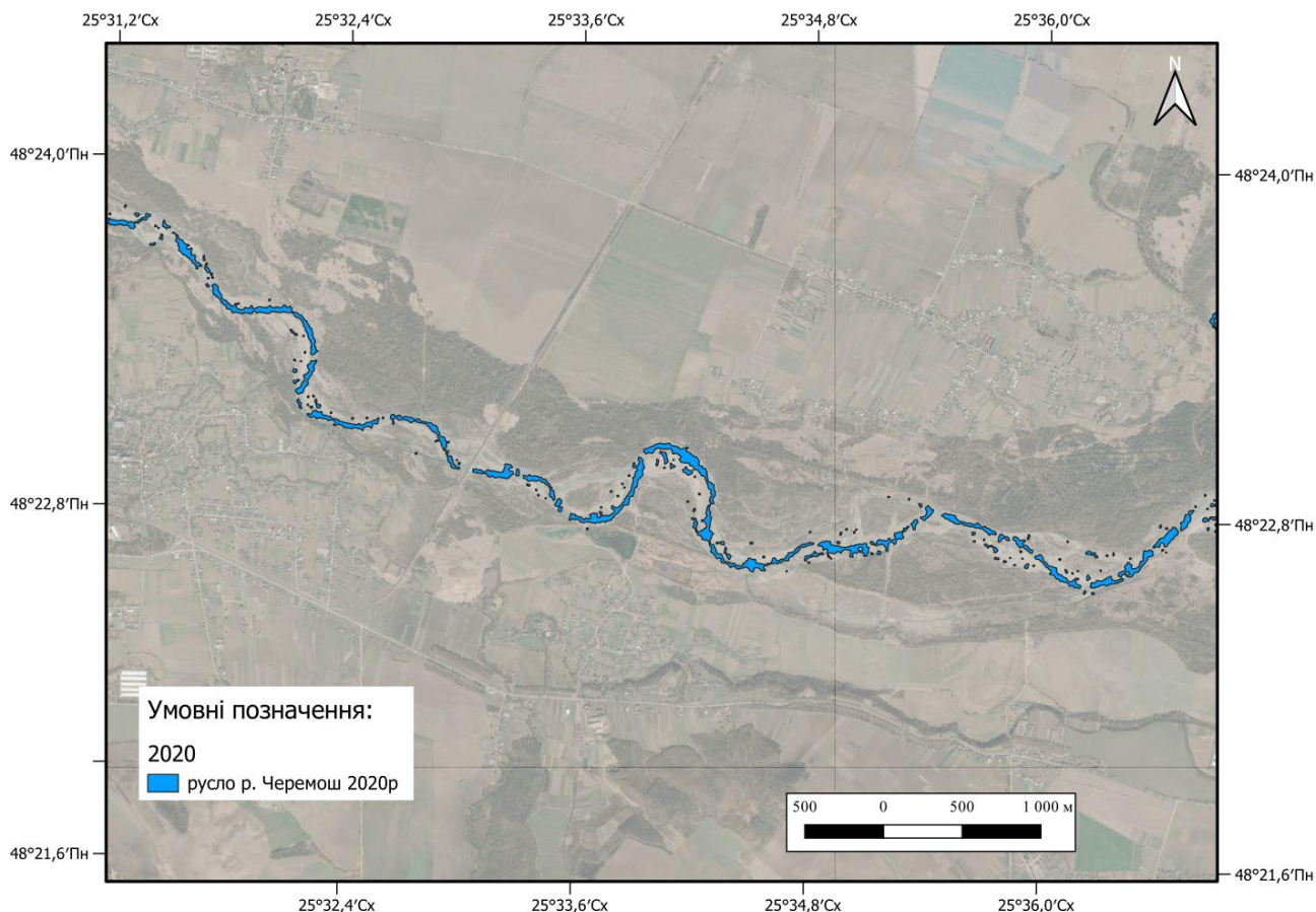
Рис. 6. Векторна модель русла річки Черемош після просторової фільтрації та морфологічного згладжування (станом на 2020 рік)
